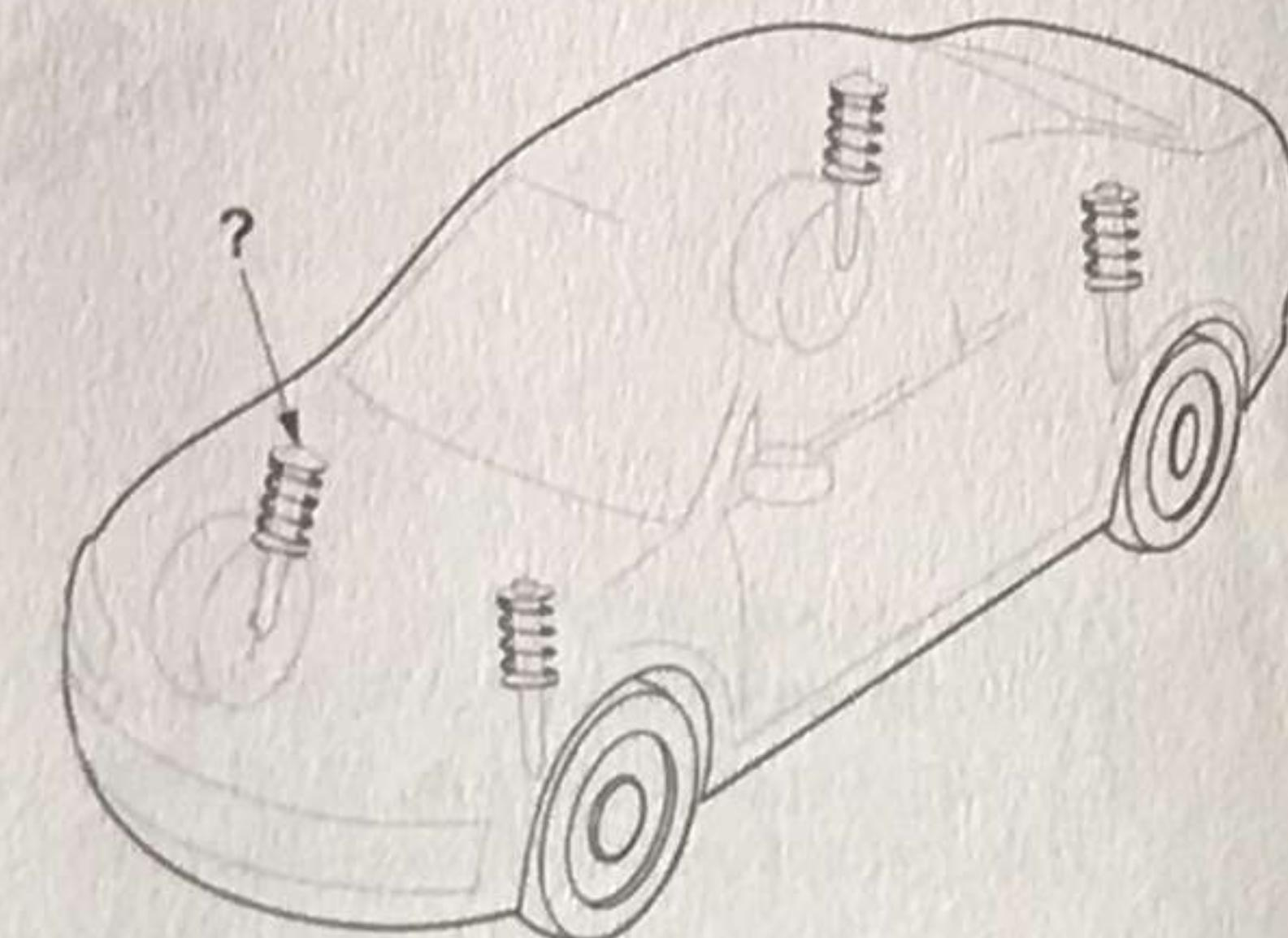
Süspansiyon sisteminde bulunan ve yay salınım süresini kısaltan, şekilde soru işareteri (?) ile gösterilmiş parça aşağıdakilerden hangisidir?
